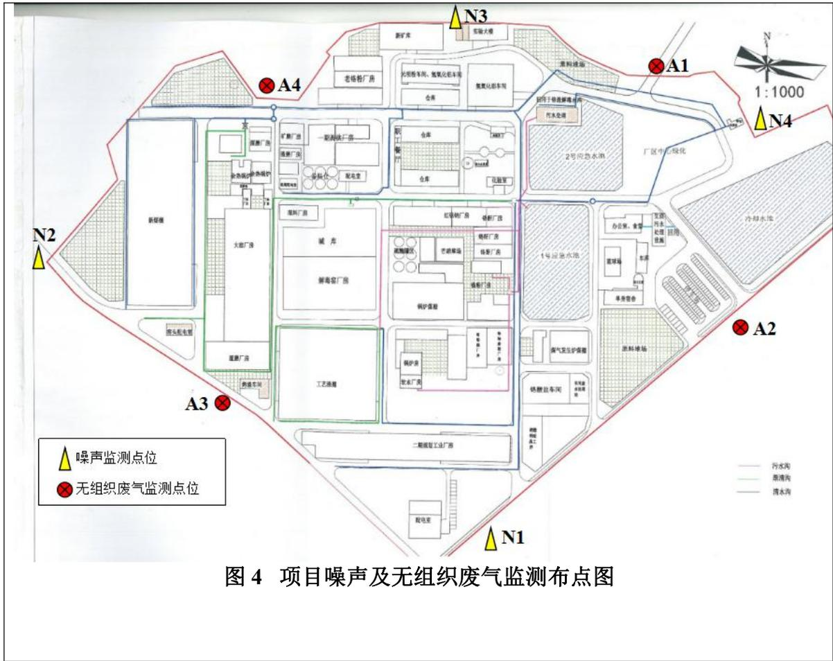
图 4 项目噪声及无组织废气监测布点图
